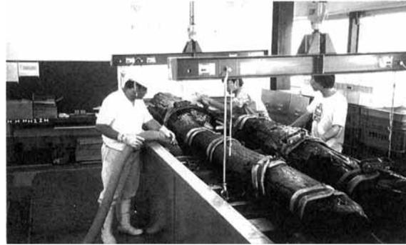
図 206 PEG 液排出と洗浄作業
