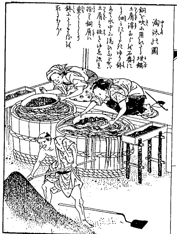
図4 「ゆりもの」 鑄型や坩堝についた銅の残りを集める作業 『江戸科学古典叢書』鼓銅図録より転載
