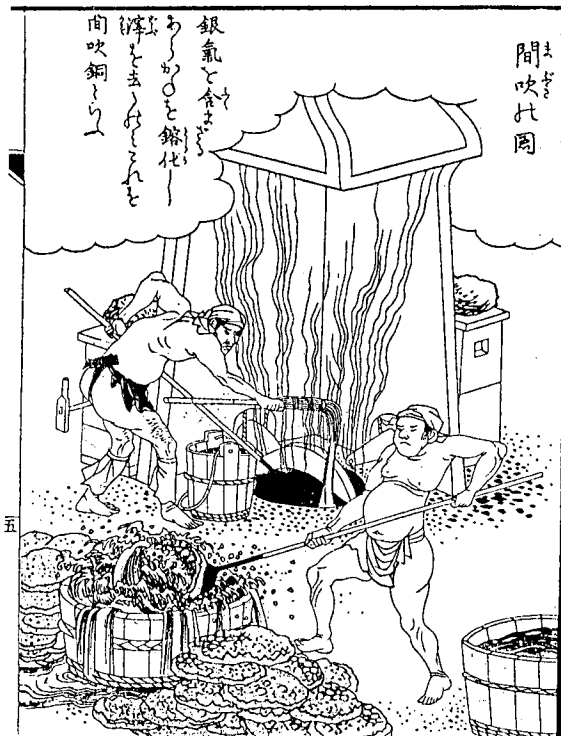
図3 「間吹き」 銅の不純物を取り除く作業 『江戸科学古典叢書』鼓銅図録より転載
