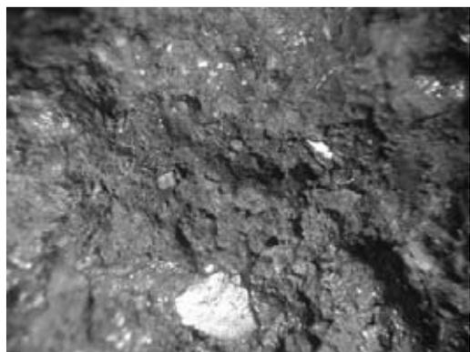
図17 鉄滓頭微鏡拡大写真(6.5倍)
