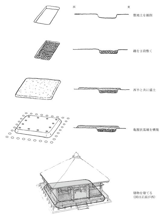
図42 建物1作業工程図
