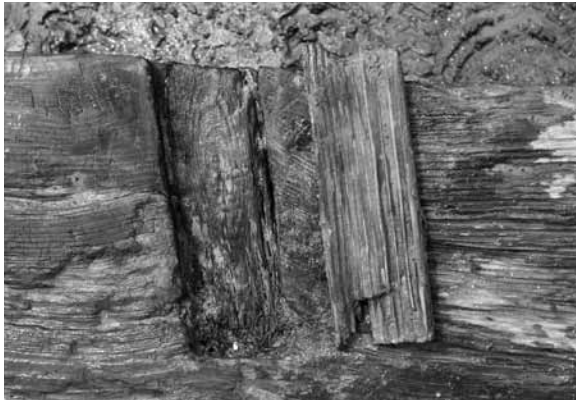
図27 川船2の死節（船内側）と材10
