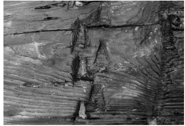
図31 川船3 通釘の台形彫り込み（船外側）
