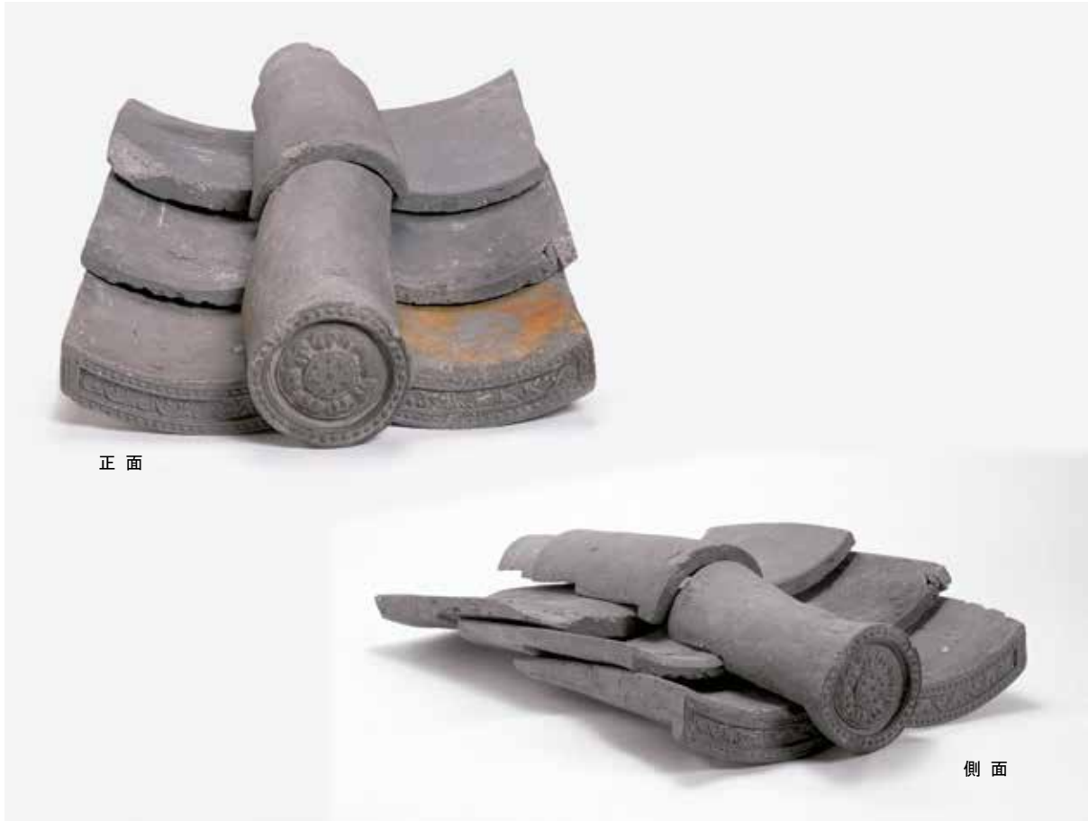
段瓦の葺き上げ状況
