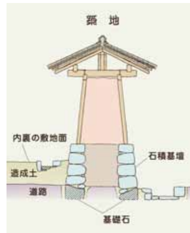
図2 寛政度内裏築地の推定断面図
