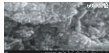
人造ベンガラ：きれいな球状微粒子をもち、中・近世以降にみられる。
